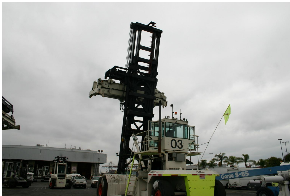
在洛杉矶港上应用 EB20 燃料的顶部处理器
